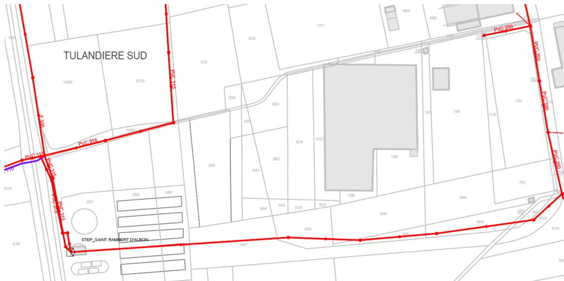
Figure 28 : Extrait du plan de récolement du réseau d'eaux usées communal. Le terrain du projet est desservi par une canalisation en PVC, diamètre 315mm.
